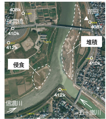
写真-1 洪水後の状況
