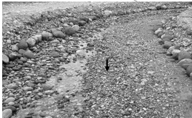
写真-5 通水後 (実験水路蛇行区間)
