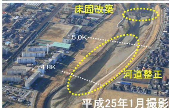
図-6 平山床固の改築及び下流河道の整備状況
