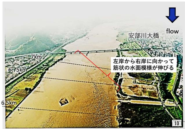
図-2 平成12年9月洪水時の安倍川7km～6.5kmにおける水面を撮影した航空写真
