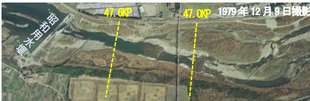
写真-2 流路の固定化が進行した昭和用水堰下流河道(1979年)
