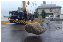
図-5 自然石+袋詰めネットの比重測定
