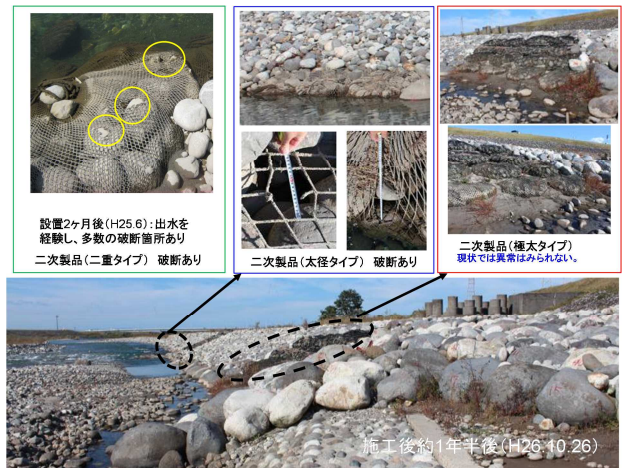
図-8 自然石+袋詰めネットのモニタリング結果
