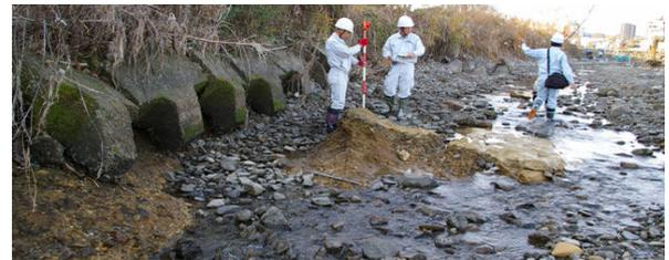
写真-6 浅川 9.2km 右岸の河岸際河床に露出した土丹
