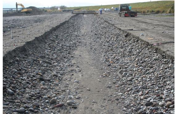
写真-4 2007年現地実験における砂の堆積状況
