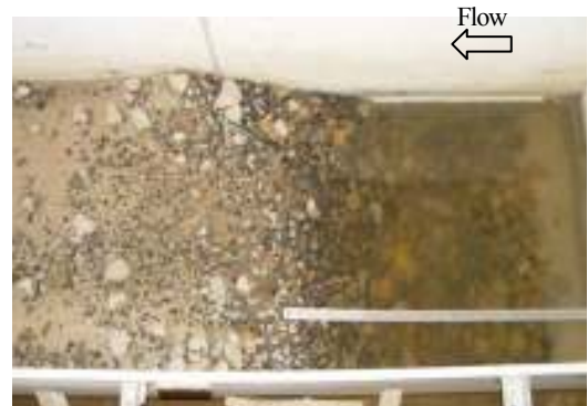
図-9 通水後の捨石の散乱状況(Case R3)
