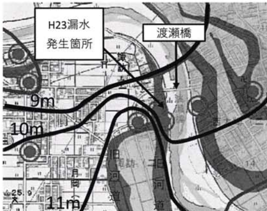
図-6 五十嵐川のH23漏水発生箇所と地下水分布図
