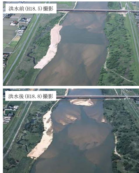
写真-1 灘橋（河口から2km）付近の洪水前後の斐伊川の状態
