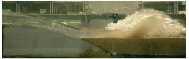
写真-1 段波突入直後(t=0.3sec.)の段波フロント形状<sup>7)</sup>
