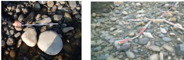
写真-2 水制周辺（左）と砂州（右）の河床表層の比較
