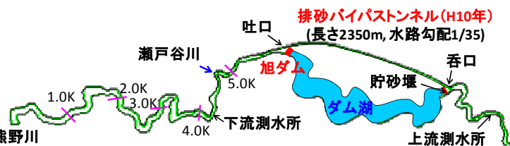
図-1 旭川周辺地図 (左) と排砂バイパストンネル平面図 (右)
