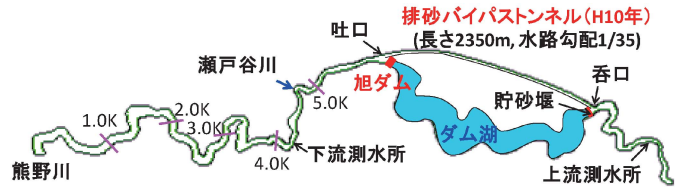
図一 旭川周辺地図(左)と排砂バイパストンネル平面図(右)
