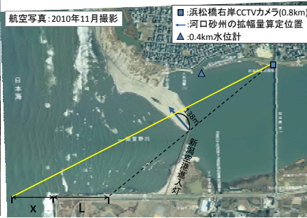
図-4 河口砂州拡幅量の算定方法
