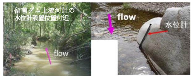
図-1 山地河川の異なる水位計設置位置の状況
