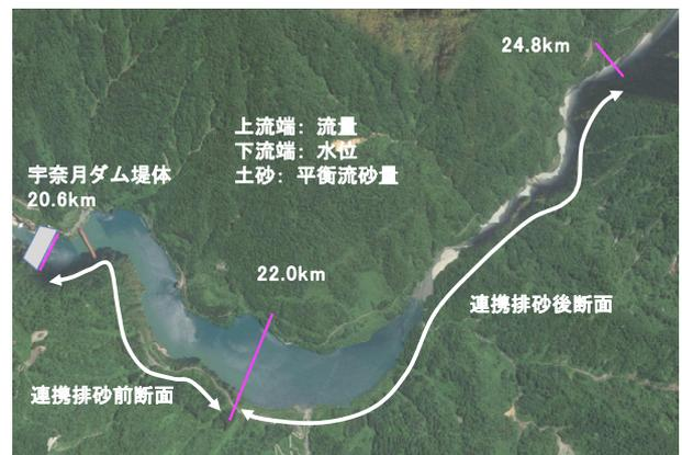
図-5 解析に用いた河道断面条件と境界条件
